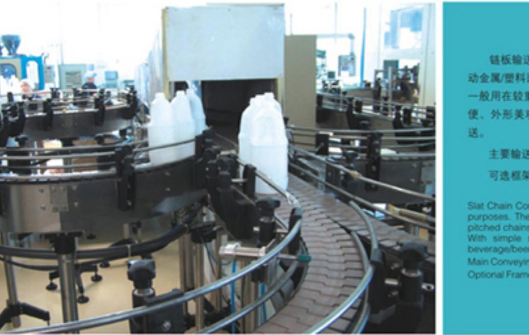
链板输送机（非标准设备）产品特点：链板输送线是以大节距特种弯板链条为传送介质，带动金属/塑料面板作循环往复运行的一种输送装配设备。由于线体结构及输送介质较为坚固，所以一般用在较重物品的输送和装配作业现场，每米的最大承重可达到800kg。其结构简单、维修方便、外形美观、运行可靠，广泛应用于饮料、啤酒、食品、制药、印刷、化妆品等行业的输送。
