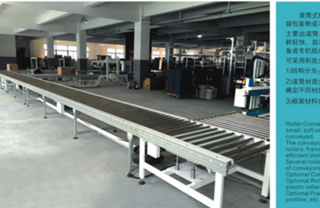
滚筒式输送机适用于底部是平面的物品输送。如各类箱、包、散料、小件物品、软袋包装物或不规则的物品需放在托盘上或周转箱内输送。
