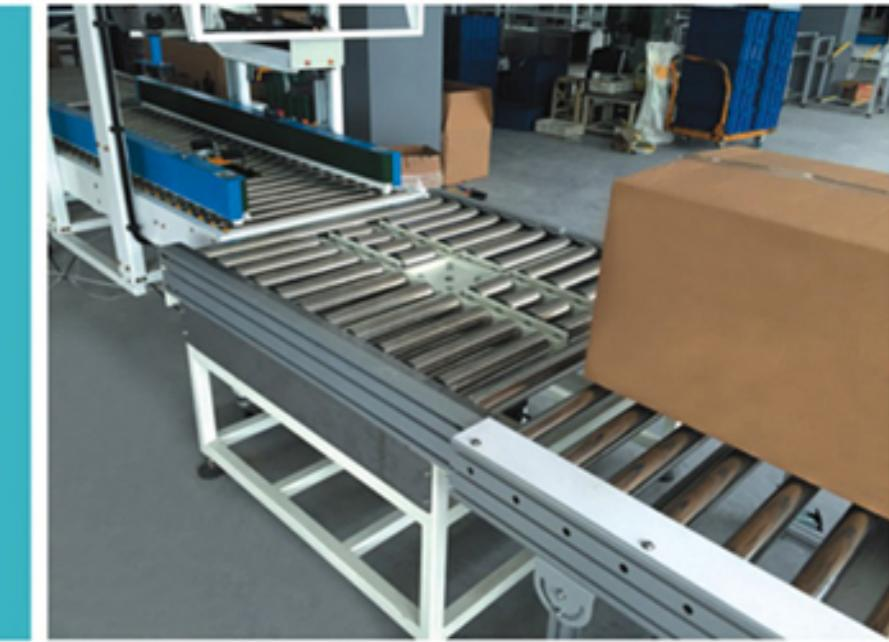
十字转向旋转机构 Cross turning rotary device
