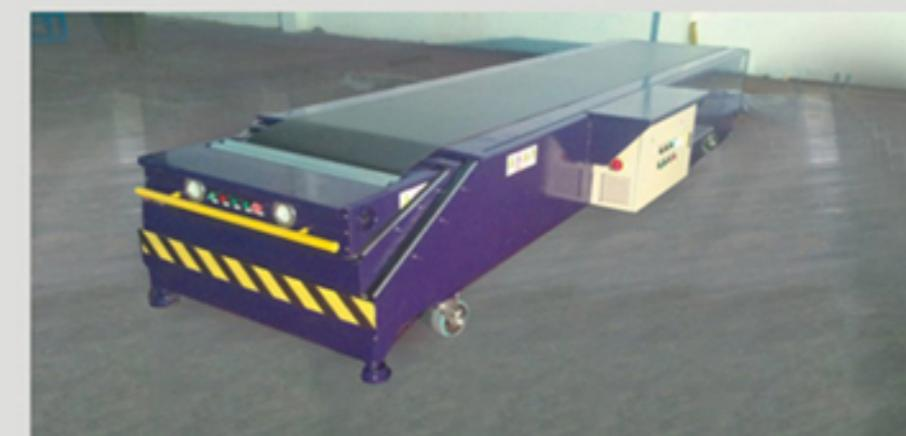
移动式三节伸缩皮带输送机
