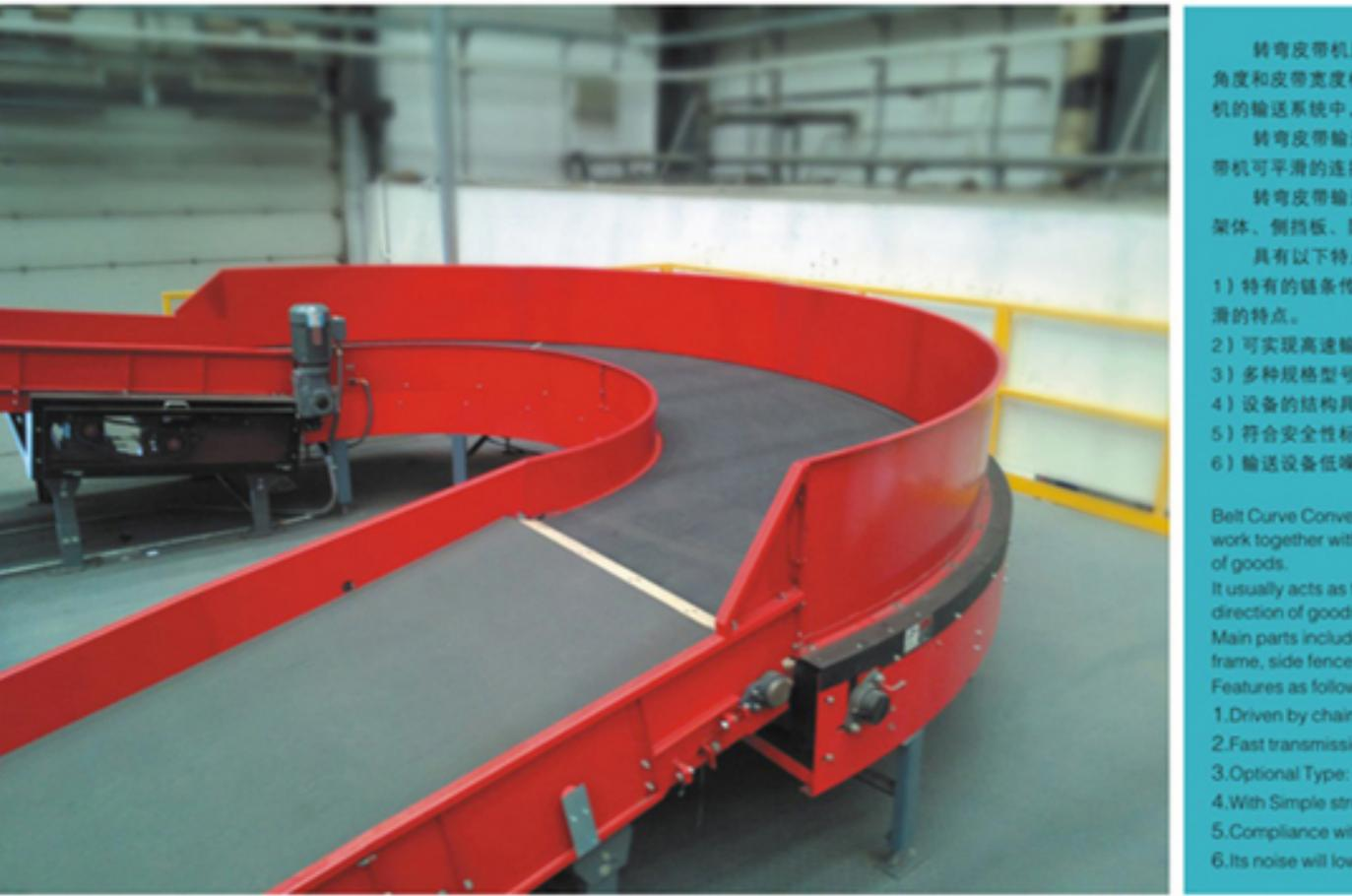
转弯皮带机用于沿曲线流输送包件货物。针对不同的应用，使用不同的角度和皮带宽度构建不同的物流曲线。通常这种装置用于连接不同种类输送机的输送系统中，实现包件货物某些流动方向。
