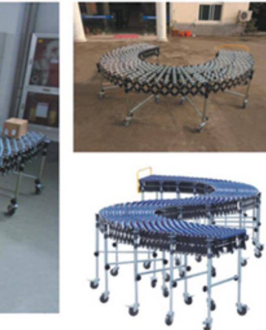
福来轮伸缩机体积小、重量轻，适合于输送底部平整的物品。多用于输送系统的弯道部分、合流部分，即可用来做水平方向的物品输送。可用于倾斜角度的物品输送，支脚通过转动手柄调节高度。即使在恶劣的地面上也能放平伸缩机，平稳运送货物。调节支脚高度，形成倾斜的输送平面，货物运送更流畅，减轻了操作人员工作强度。
