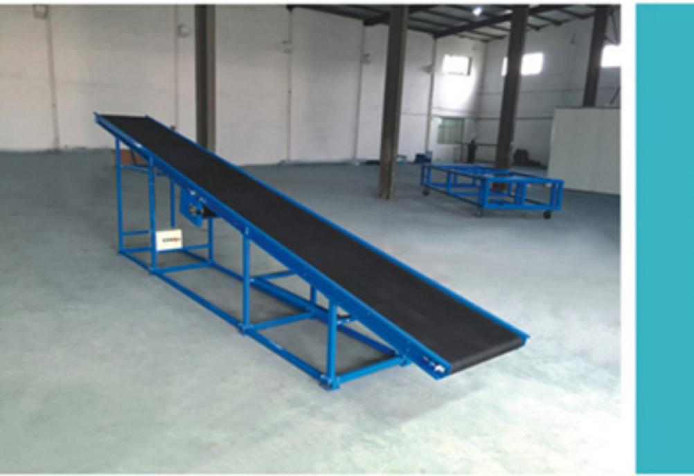
倾斜皮带输送机是组成有节奏的流水作业线所不可缺少物流输送设备。爬坡皮带输送机具有输送能力强，输送距离远，结构简单易于维护，能方便地实行程序化控制和自动化操作。运用输送带的连续运动来输送，其运行高速、平稳、噪音低。
