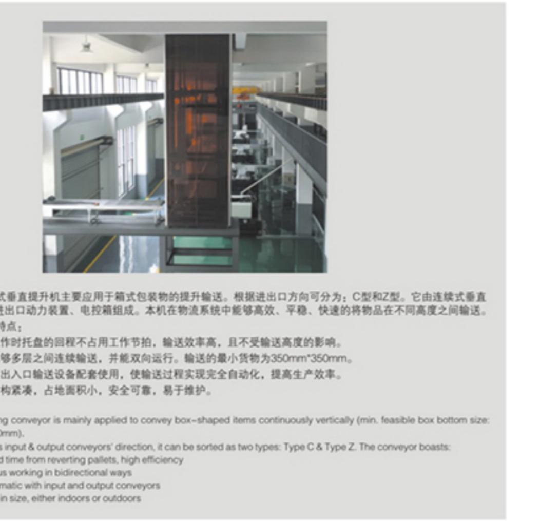
连续式垂直提升机主要应用于箱式包装物的提升输送。根据进出口方向可分为：C型和Z型。它由连续式垂直输送机、进出口动力装置、电控箱组成。本机在物流系统中能够高效、平稳、快速的将物品在不同高度之间输送。
