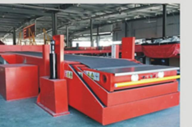
伸缩皮带机前端控制机构
