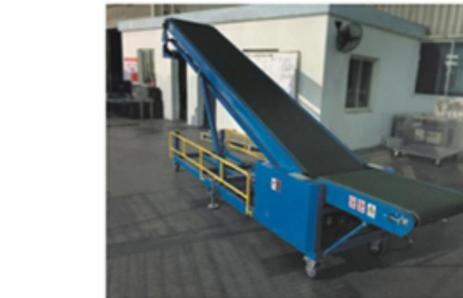
•可调式爬坡皮带输送机 Flexible Climbing conveyor
